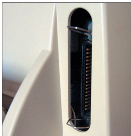
Рис. 12. Проследите, чтобы защелки попали в прорезь для LPT-порта
