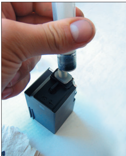
Рис. 5. Ставим шприц на дюзы и аккуратно начинаем чистку
