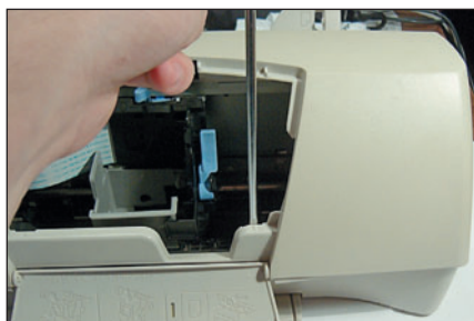
Рис. 6. Здесь находятся защелки
